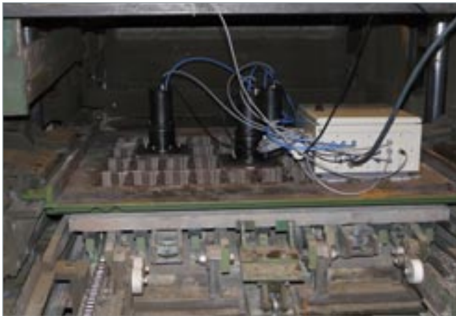
12: Przyrząd pomiarowy zamontowany w wibroprase.
