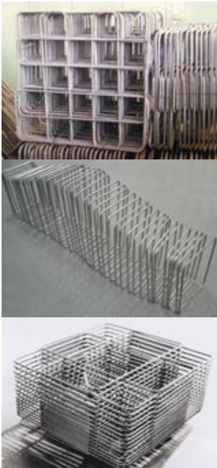
Seria Spiral SE to druga generacja maszyn do prostowania, gięcia i cięcia stalowych prętów produkujących strzemiona w postaci ciągłej, wielowarstwowej spirali.
